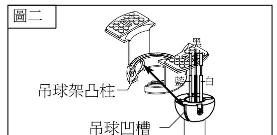
警告：為避免火災或電擊，在固定吊鐘時請確認電線全部在吊鐘裡面。
